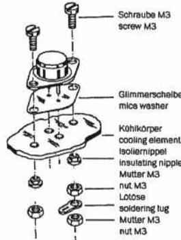
Bei der Montage auf einen gemeinsamen Kühlerkörper müssen Isoliernippel und Glimmerscheiben verwendet werden (nicht im Bausatz enthalten). Bei getrennten Kühlerköpfen können die Isoliernippel und Glimmerscheiben entfallen.
